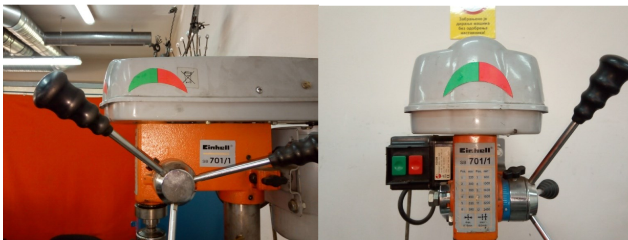
Слика 20. Зелена половина „смајлија“ показује радни, а црвена повратни ход ручице на бушилици
