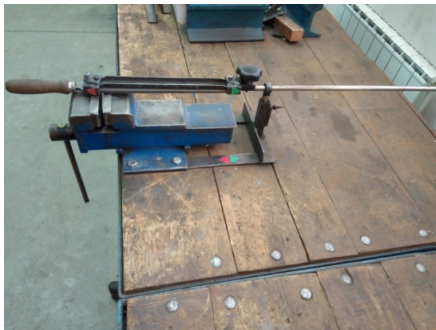
Слика 13. Асистивни алат за увежбавање обраде турпијањем
