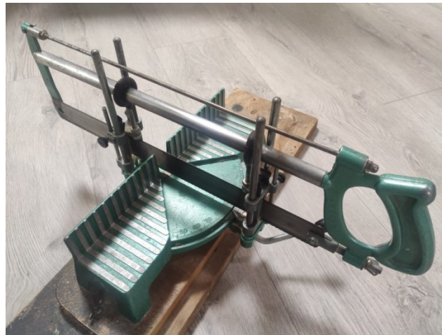
Слика 16. Куповни алат за сечење (рем) погодан за увежбавање сечења ручном тестером
