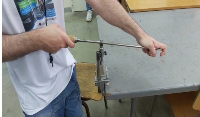
Слика 15. Асистивни алат за процену манипулативних способности везаних за операције: обрада турпијањем, одсецање ручном тестером и хобловање
