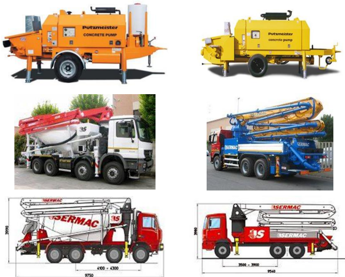
Слика 31. - Пумпе за бетон
