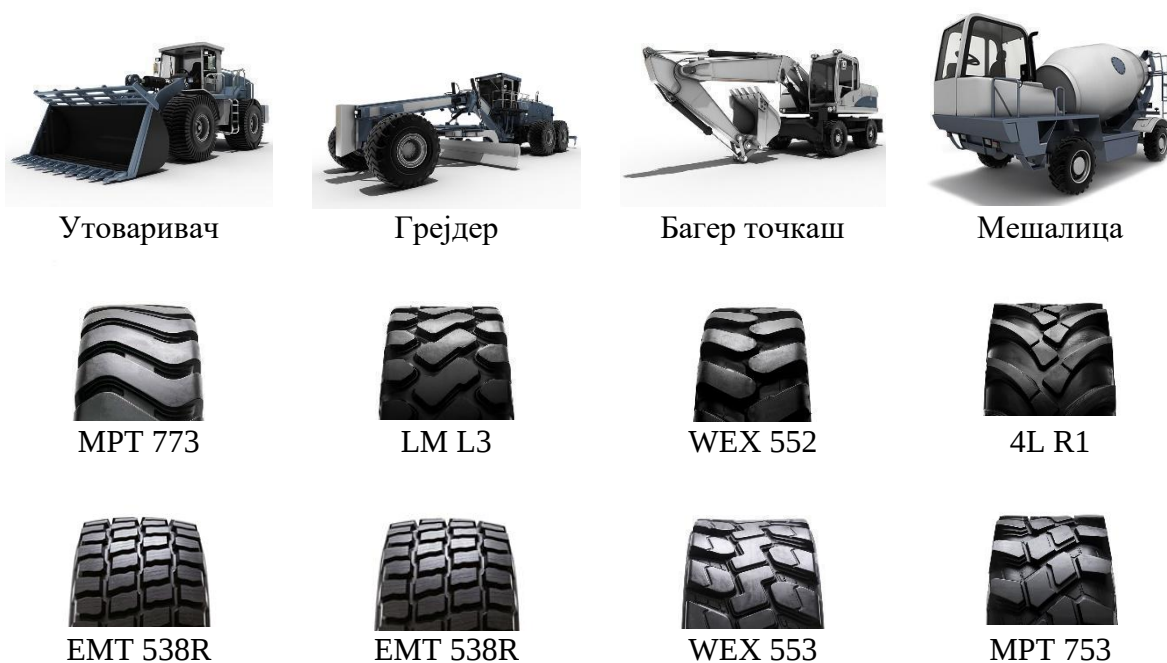
Слика 33. - Изглед неких типова пнеуматика са газиштем
