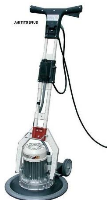
Машине глачалице-машине за равнање и глачање подне кошуљице
