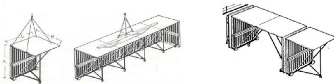
Слика 108. - Просторну целину оплате чине парови полушкољки
