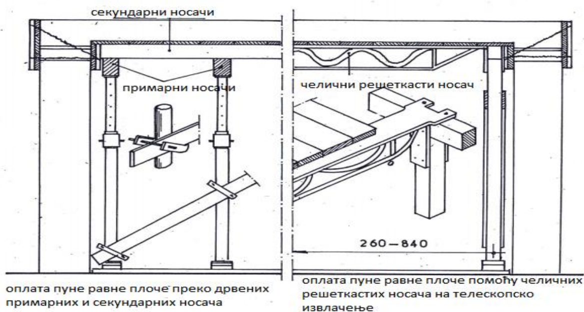
Слика 86. - Оплата равних плоча
