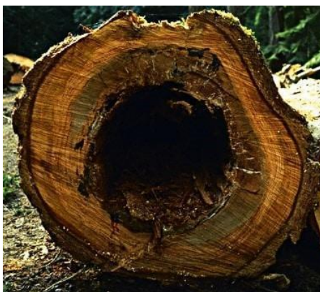
Слика 21. - Централна трулеж
