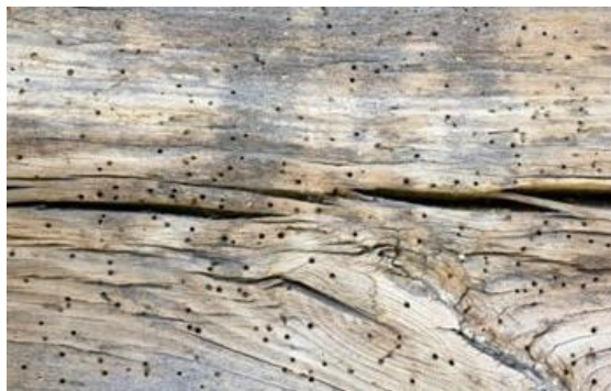
Слика 23. - Грешке од инсеката
