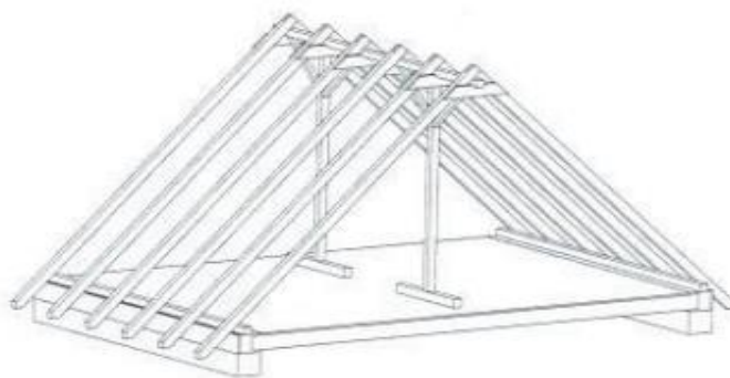
Слика 121. - Кров на једнострукој правој столици
