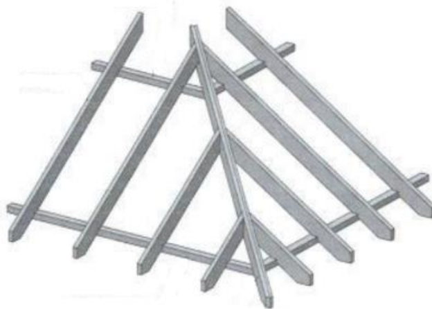
Слика 142. - Троугаона кровна раван тзв. полуносач
