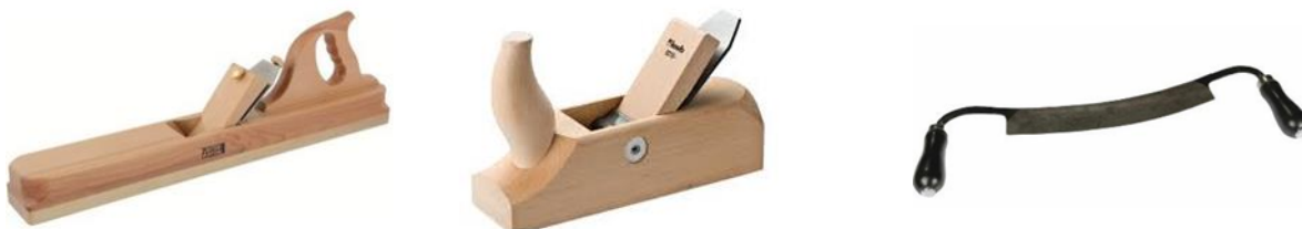
Слика 51. - Макља за скидање коре дрвета
