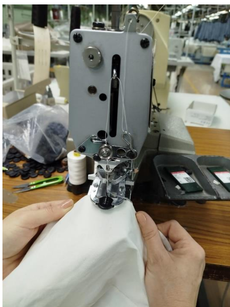
Слика 36. - Нашивање дугмади на шиваћем аутомату
