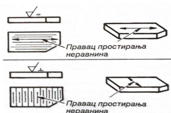
Слика 74. - Означавање правца простирања неравнина
