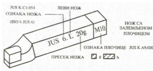
Слика 173. - Различити облици и ознаке ножева
