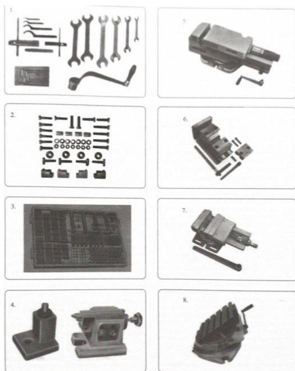
Слика 231. - Прибор за придржавање обратка при глодању
