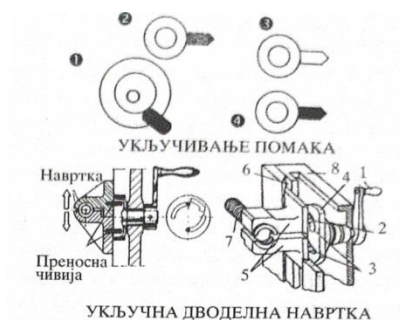
Слика 210. - Преносни однос при резању навоја
