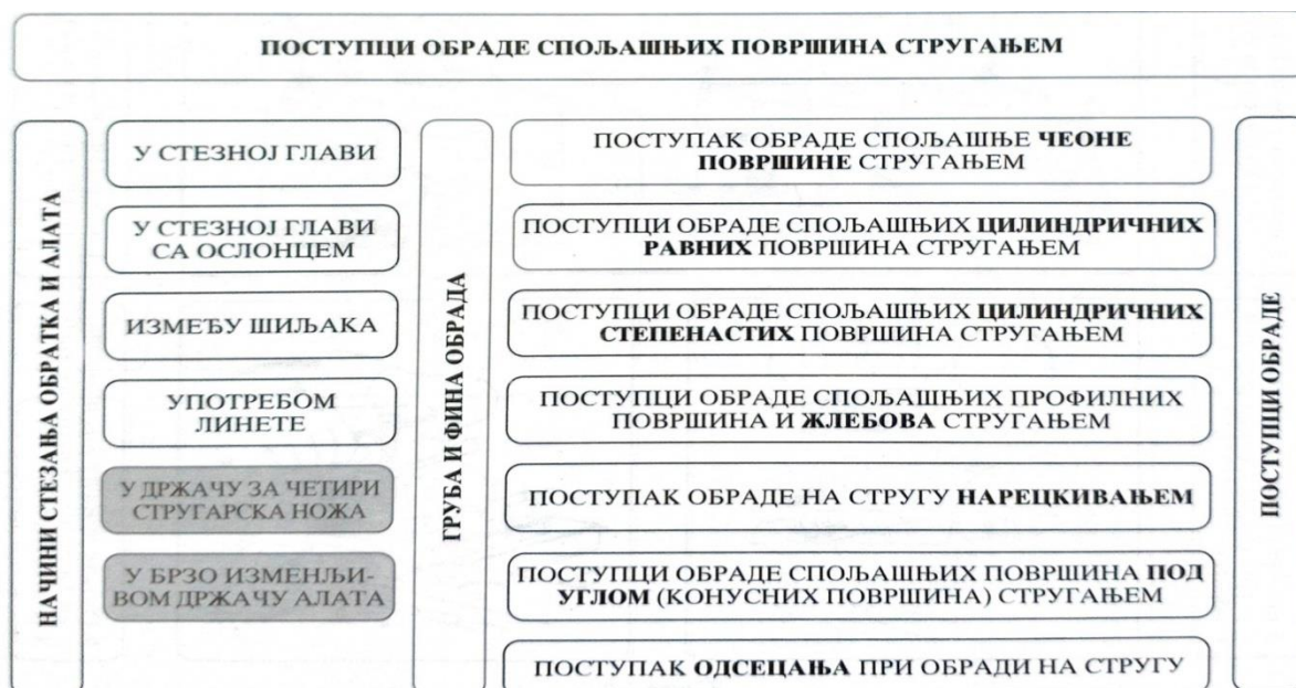
Слика 184. - Поступци обраде спољашњих површина стругањем
