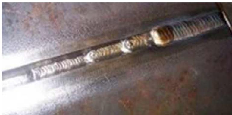
Слика 72. - TIG вар са више пролаза
