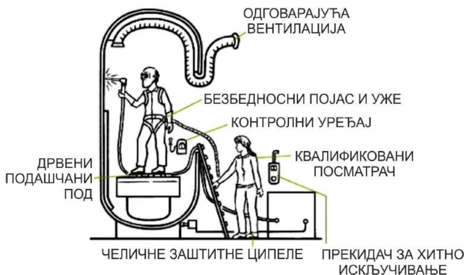
Слика 87. - Заваривање у ограниченом простору.
