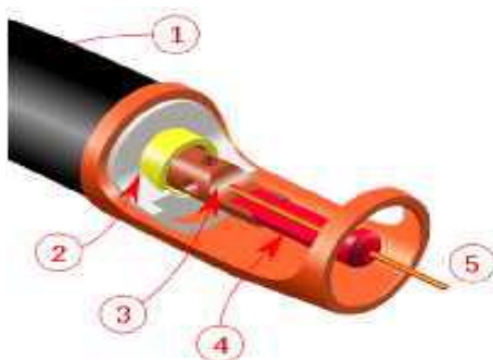
Слика 74. - Изглед пиштоља за заваривање MIG поступком
