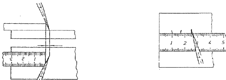
Слика 12. - Правилно и неправилно руковање иглом за оцртавање
