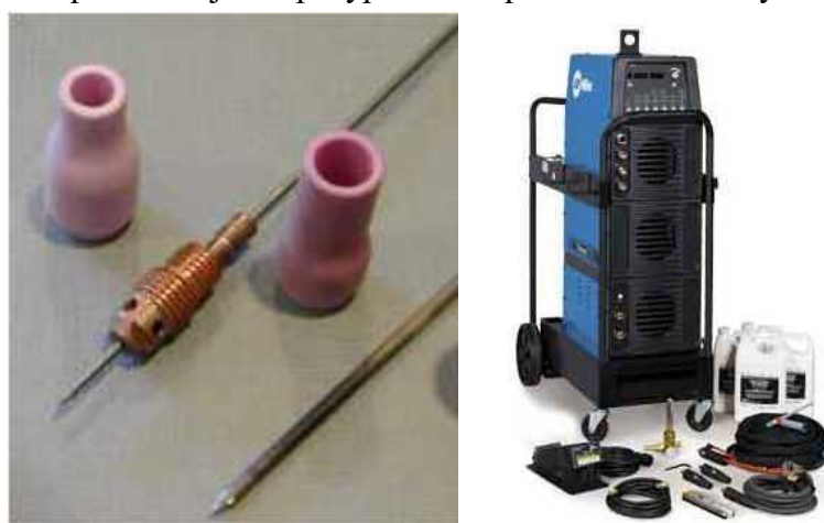
Слика 73. - Апаратура за заваривање TIG поступком
