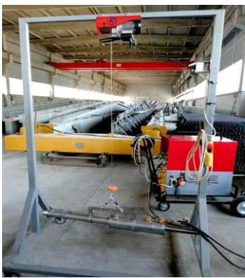
Слика 74. - Преса за преднапрезање појединачних ужади-Тип Лока
