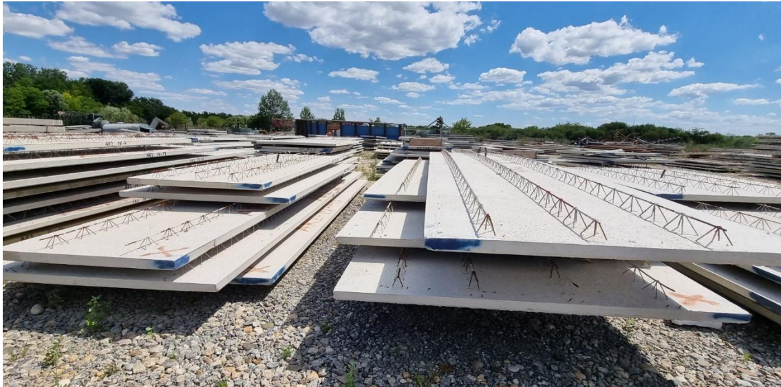
Слика 98. - Префабрикована бетонска (Омниа) плоча са решеткастим носачем
