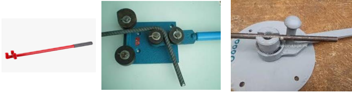
Слика 12. - Савијање арматуре
