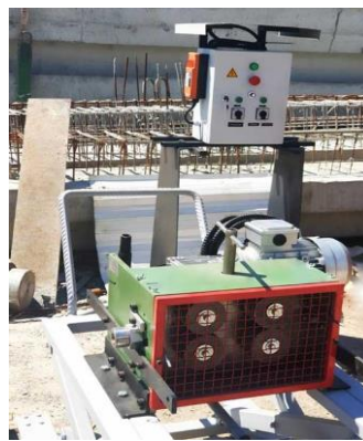
Слика 75. - Машина за увлачење ужади у калупе
