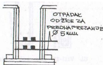
Слика 58. - Утврђивање каблова помоћу подметача
