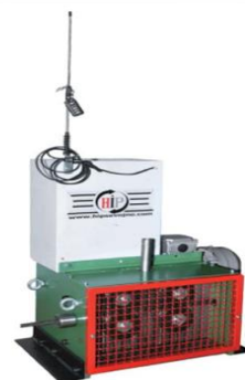
Слика 78. - Машина за увлачење ужади у калупе
