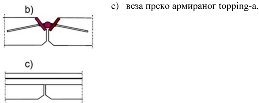
Слика 115. - Веза панелних елемената плоче међуспрата
