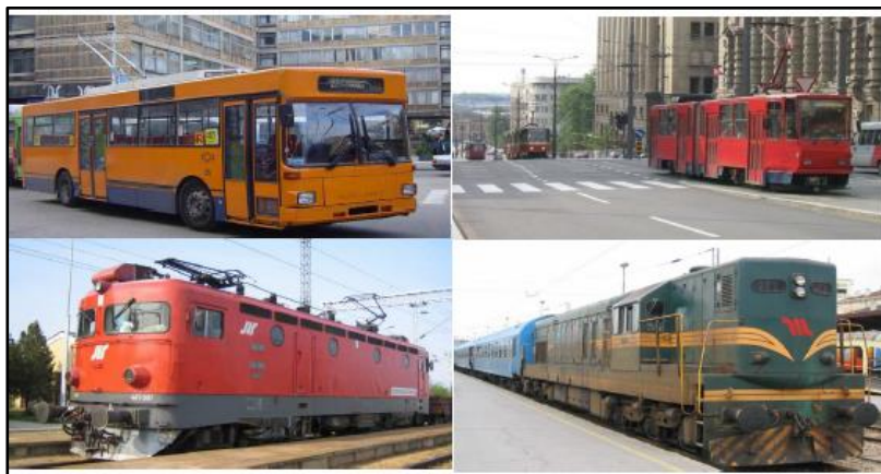
Слика 401. - Примена мотора једносмерне струје у електричној вучи
