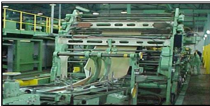
Слика 402. - Примена мотора једносмерне струје у индустрији – машина за израду папирних џакова
