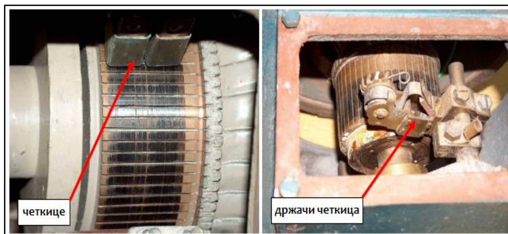
Слика 372. - Комутатор машине једносмерне струје
